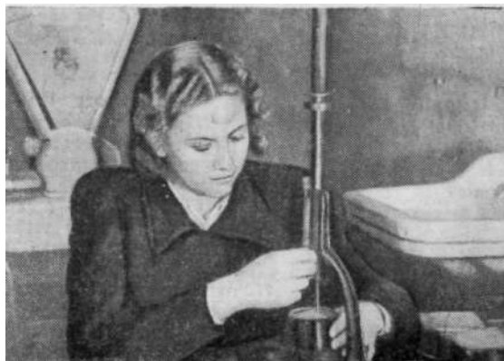
Научный сотрудник Института строительства и строительных материалов Академии наук Эстонской ССР А. Кульдмаа определяет время схватывания нового вида сланцевого цемента.
